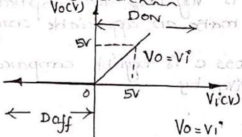
$$V_o = V_i - 0.7 \quad V_i > 0.7V$$
